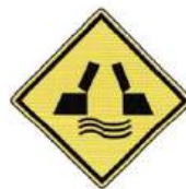
2-33 สะพานเปิดได้
